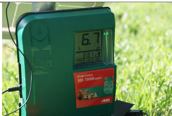
Fliesst mehr als 4500 Volt durch den Zaun, gilt dieser als wolfsicher
